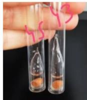
Figure 13. (a) Exemples de tablettes de céramique. (b) Montage expérimental montrant deux tablettes de céramique plongées dans un vin modèle, contenu dans un tube de 7 mm scellé, lui-même inséré dans un tube de RMN de 10 mm.
